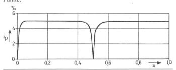
Fig. 1 Courant statorique pulsant relatif en fonction du glissement pour une barre cassée, moteur 1
