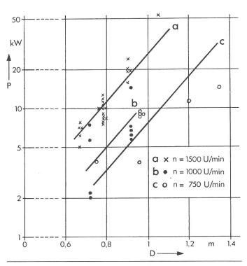
Fig. 1 Gesamte Ventilationsverluste P in Funktion der Statorbohrung D L=0.5...0,64 m
