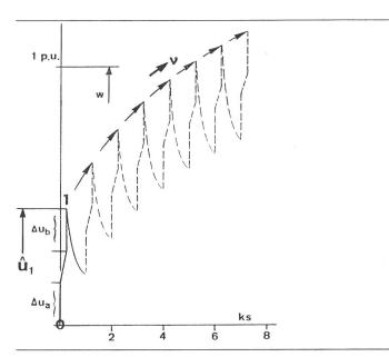
Fig. 5 S5-Betrieb des Elektromotors
