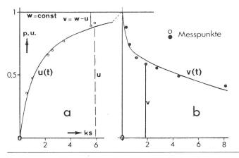
Fig. 3 Berechnete und gemessene Dauerbetriebskurven Übergangskurven zum Dauerbetrieb mit Nennlast
