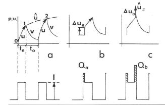
Fig. 4 Verlauf der Wärmeeinströmung und der Erwärmung in verschiedenen Schaltbetriebsarten eines Motors
