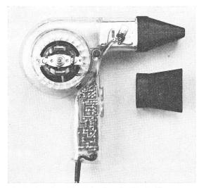
Fig. 2 Anordnung der Printplatte im Handgriff
