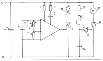
Fig. 1 Schaltschema eines elektronisch regelbaren Haartrockners
