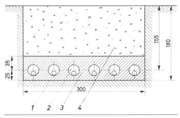
Fig. 23 Verlegung der Kabel in Kunststoffrohre in Rohrblock (Querschnitt)
