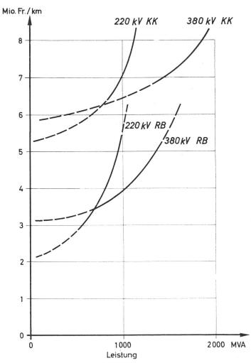
$\begin{array}{ll} \textbf{Fig. 26} & \textbf{Investitionskostenvergleich} \\ & \textbf{Rohrblockanordnung-Kabelkanal 2} \times 3 \times q \end{array}$
