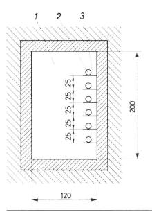
Fig. 24 Verlegung der Kabel in begehbarem Kabelkanal (Querschnitt)
