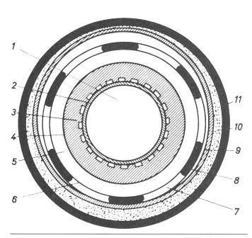
Querschnitt durch ein 410-kV-Hochleistungskabel mit innerer Wasserkühlung. Maßstab 1:2,4
