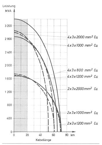
Fig. 2 380-kV-Kabel (Werte mit 400 kV errechnet)
