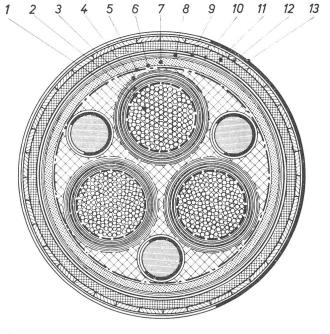
Fig. 4 Ouerschnitt durch ein 60-kV-Dreileiter-Ölpapierkabel Typ PPbOf-TFg h
