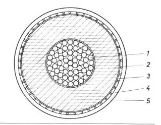
Fig. 10 Querschnitt durch ein 60-kV-Einleiter-Polyäthylenkabel Typ TKT/XKT (siehe auch Tabelle I für Legende) Querschnitt 1×630+50 mm². Maßstab 1:1,2
