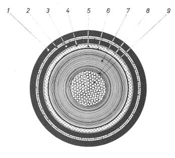
Ouerschnitt durch ein 130-kV-Einleiter-Gasinnendruckkabel Fig. 7 Typ PigPb-TFFT
