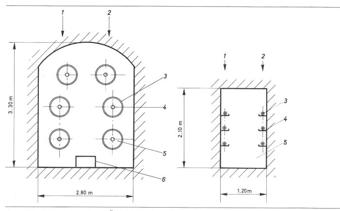
Fig. 15 Vergleich Rohr-Gaskabel-Anlage mit Ölkabel für 220 kV. Querschnitte durch die Anlagen
