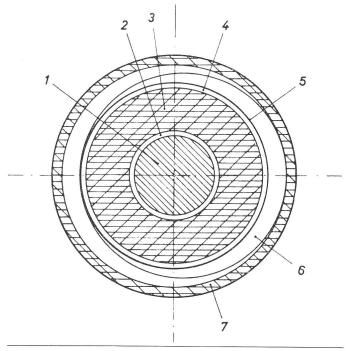
Fig. 11 Querschnitt durch ein gasimprägniertes 150-kV-Einleiter-Polyäthylenkabel mit SF<sub>6</sub>, Typ TgCuT
