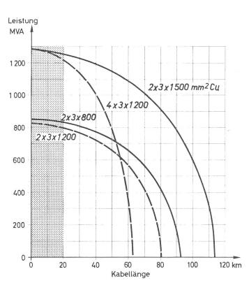
Fig. 1 220-kV-Kabel (Werte mit 230 kV errechnet)
