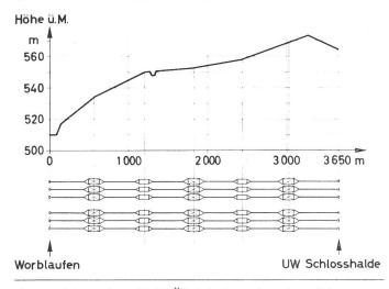
Fig. 19 Schema einer 150-kV-Ölkabelanlage mit zwei parallelen Strängen des Elektrizitätswerkes der Stadt Bern (1952)
