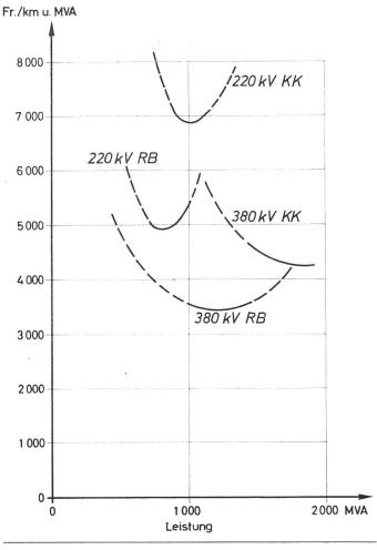
Fig. 27 Investitionskostenvergleich Rohrblock-Kabelkanal  $2 \times 3 \times q$
