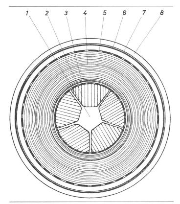
Querschnitt durch ein 220-kV-Einleiter-Ölpapierkabel Fig. 3 Typ PPbOf-T spez.
