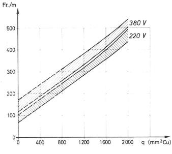
Fig. 28 Preise für 220-kV- und 380-kV-Kabel in Abhängigkeit des Querschnittes (Einleiterkabel; für einen dreiphasigen Strang dreifache Kosten)
