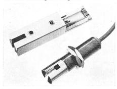
Elektrisch zeichnet sich der Schlitzinitiator durch einen grossen Betriebsspannungsbereich von 5...24  $V_{\rm =}~(\pm 20~{\rm ^0/o})$  aus. Sein eingebauter Leistungsausgang kann bis 200 mA schalten. Neben verschiedenen Bauformen wird der Schalter mit dicht eingegossenem Kabel oder Steckanschluss gefertigt.
