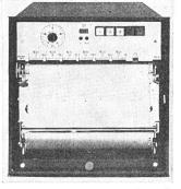
Schreiber steht normalerweise still oder läuft mit langsamem Vorschub ab. Bei Störung wird der Vorschub auf 20 mm/s erhöht. Dank der Speicher werden nun alle Werte 2 s vor, während und nach der Störung so gedehnt aufgezeichnet, dass auch schnell veränderliche Vorgänge einwand-
