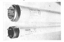
Index R<sub>a</sub> hohe Werte, die der Stufe 1 der Leitsätze der SLG (Schweiz. Lichttechnische Gesellschaft) zugeordnet werden können. Durch Reduktion des Durchmessers von 38 auf 26 mm konnte die Lichtausbeute der neuen Lampe auf über 90 lm/W gesteigert werden. Die Leistungsaufnahme der Lampe verringert sich dadurch gegenüber den bisherigen Dreibandentypen auf 18, 36, bzw. 58 W. Der Betrieb kann jedoch mit vorhandenen Leuchten und normalen Vorschaltgeräten 20, 40 und 65 Werfolgen.
