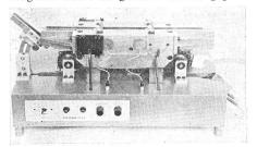
werden. Während des Prüfvorganges durchlaufen die Magnete alle für eine Qualitätskontrolle erforderlichen Zustände: 1) Aufmagnetisierung bis zur Sättigung, 2) Messen des erreichten Gesamtflusses, 3) Schwächen zum Erreichen eines gewählten Punktes auf der Magnetisierungskurve, 4) Messen des noch verbliebenen Gesamtflusses, 5) Entmagnetisieren, 6) Sortieren der Magnete nach ihrem Gesamtfluss.
