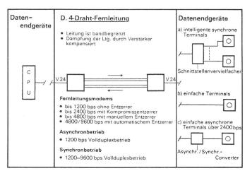
Fig. 9 Einsatzmöglichkeiten von Datenübertragungsgeräten über Telefon-Mietleitungen
