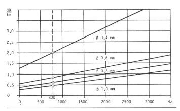
Fig. 3 Typischer Dämpfungsverlauf pro km von unpupinisierten Leitungen (Ortsleitungen)
