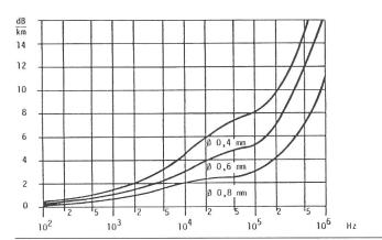
Fig. 1 Wellendämpfungsbelag von NF-Kabeln
