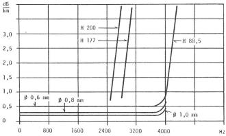
Fig. 5 Typischer Dämpfungsverlauf pro km von pupinisierten Leitungen
