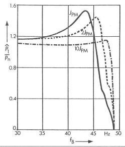
Fig. 12 Pendelleistungen  $\hat{P}_1$  der Asynchronmaschine bezogen auf die Nennleistung  $P_n$   $J_{PM}$  Massenträgheitsmoment der ungekuppelten Asynchronmaschine (Maschine 2 mit Schleifringanker)
