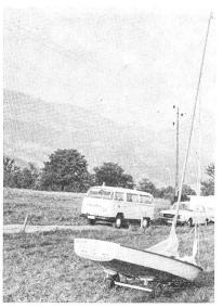
Fig. 4 Dieses Segelboot wurde auf dem Rollschemel über Land gezogen und geriet mit dem Mast in eine Freileitung
