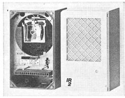
Der passive Infrarotmelder detektiert die vom Menschen ausgehende Infrarotstrahlung Diese wird über ein Spiegelsystem auf ein Bolometer oder einen pyroelektrischen Wandler fokussiert. Das äusserst schwache Wandlersignal wird verstärkt und nach verschiedenen Kriterien ausgewertet
