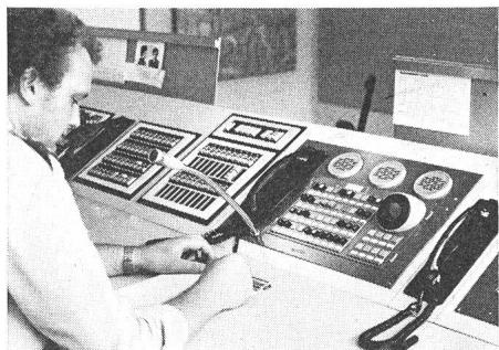
schlüsselt die gesprochene Sprache auto-matisch und ohne jede Behinderung des Funkverkehrs. Die angewendete Methode der Zeitschlüsselung eignet sich für alle bekannten Funksysteme. Die Übertragung über die meisten Drahtverbindungen ist ebenfalls möglich.
