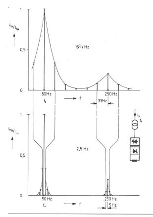
Fig. 9 Netzstrom-Amplitudenspektrum beim idealen einphasigen Direktumrichter bei zwei verschiedenen Lastfrequenzen  $(f = 16^2)_3$  Hz und 2,5 Hz)
