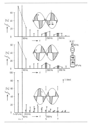
Fig. 11 Oberschwingungsspektrum des Netzstromes beim wirklichkeitsnahen, einphasigen Direktumrichter  $f=16,66~{\rm Hz};~u_{\rm gm}/U_{\rm dio}=0,9;~\varphi_2=60^{\rm 0}$  Computergestützte Untersuchung. Für Phase T auch Vergleich mit dem Idealfall
