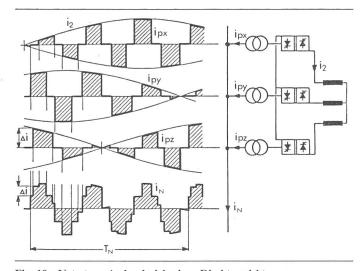
Fig. 10 Netzstrom  $i_N$  des dreiphasigen Direktumrichters Er wird aus drei um  $120^0$  el. versetzten Transformatorströmen  $i_p$  der einzelnen Umrichterphasen gebildet (idealisiert). Maßstab  $i_N/i_p = 1/2$
