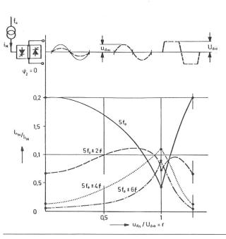
Fig. 7 Abhängigkeit der 5. Stromoberschwingung und deren Seitenschwingungen vom Aussteuerungsgrad  $u_{\rm dm}/U_{\rm dio}$  des einphasigen Direktumrichters
