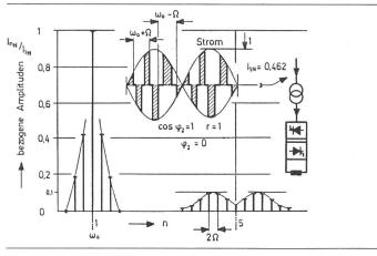
Fig. 5 Netzstrom-Amplitudenspektrum des idealen einphasigen Direktumrichters im maximalen Steuerbetrieb und bei  $\varphi_2=0$
