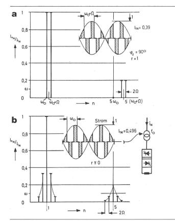
Fig. 6 Netzstrom-Amplitudenspektrum des idealen einphasigen Direktumrichters
