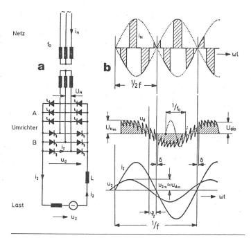
Fig. 1 Einphasiger Direktumrichter mit zwei antiparallelen Drehstrombrückenschaltungen
