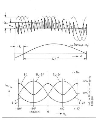
Fig. 8 Abhängigkeit der 5. Stromoberschwingung und der nächsten Seitenschwingungen vom Phasenwinkel  $\varphi_2$  Aussteuerungsgrad  $u_{\rm dm}/U_{\rm dio}=0,4$ . Beim dreiphasigen Direktumrichter fällt die Seitenschwingung mit 2f aus (es bleibt  $5\pm 6f$ )
