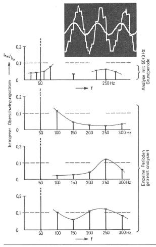
Das Amplitudenspektrum von einzelnen Netzstromperioden ist ganz anders gestaltet als das Spektrum bei einer Langzeitanalyse Dreiphasiger Direktumrichter im Trapezbetrieb
