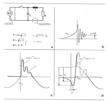
Fig. 1 Ausschaltspannungen eines einfachen einphasigen Schwingkreises
