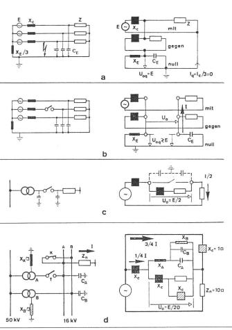
Fig. 2 Unsymmetrieschaltungen in symmetrischen Komponenten
