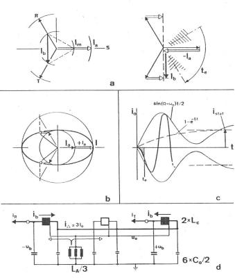
Fig. 3 Transiente Vorgänge zwischen dem ersten Lastwechsel in der a-Achse und dem Hauptausschalten in der b-Achse (1 Trafo vollständig aus)
