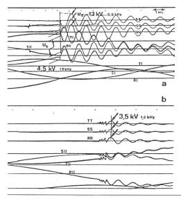
Fig. 4 Oszillogramme zum Trafo-Lastumschalten
