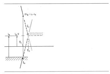
Fig. 5 Gleichzeitiges Löschen in der b-Achse  $(i_{\rm R,T}-i_{\Delta}/2)$  bedingt Abreissen eines Nullstromes  $(i_{\Delta}/2)$
