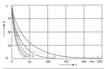
Fig. 6 Amplitudengang analog Fig. 3 Jedoch für 30 m Leitungslänge,  $\varepsilon_{r0}=2,82,\ tg\,\delta_0=0,0309$
