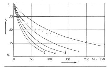
Fig. 4 Amplitudengang analog Fig. 3 Jedoch für 10 m Leitungslänge,  $\varepsilon_{r0}=2.83, \ tg \, \delta_0=0.0315$
