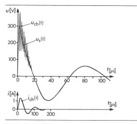
Résultats des calculs de tension et courant effectués à l'aide du programme TRANSIENT
