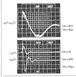
Fig. 4 Résultats des mesures de tension et courant  $u_s(t)$  Tension aux bornes du système perturbateur  $u_{ch}(t)$ ,  $i_{ch}(t)$  Tension et courant du système perturbé
