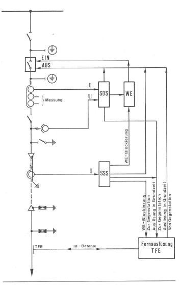
Fig. 7 Leitungsfeld in einpoliger Darstellung mit Schutzkreisen
