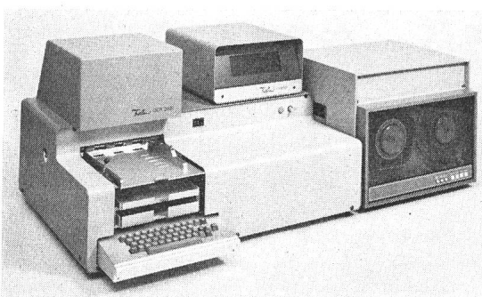
Fig. 8 Universeller Seitenleser mit Eingabetastatur, Kontrollschirm und Magnetbandstation
