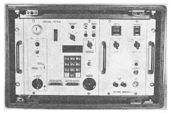
Fig. 6 Modernes Datenchiffriergerät
