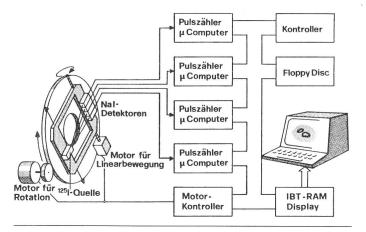
Fig. 6 Schematische Darstellung eines  $\gamma$ -Strahlen-Computertomographen
