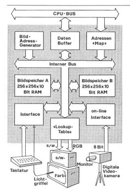
Fig. 1 Schematische Darstellung des IBT-RAM Display Systems
