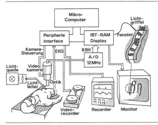
Fig. 3 Computer-assistierte Videomikroskopie für die quantitative Untersuchung der Transport- und Austauschprozesse im Kapillarbett
