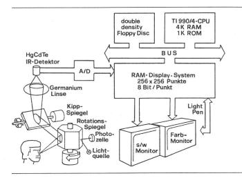
Fig. 2 Mikrocomputer-Thermographiesystem; Blockschema
