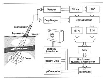
Fig. 9 Schematische Darstellung eines computer-assistierten 128kanaligen Ultraschallgerätes für nicht-invasive Kreislaufuntersuchungen
