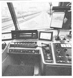
Fig. 9 Eingliederung des Anzeigegerätes im Führerstand (Re4/4<sup>II</sup>)
