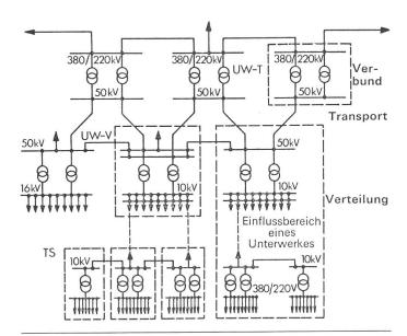
Fig. 1 Die Hierarchie des Energienetzes
