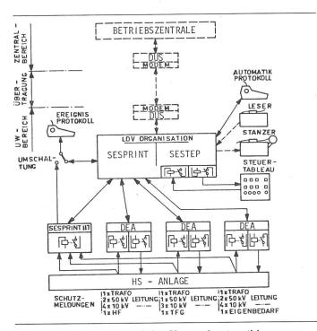
Fig. 5 Blockschema einer typischen Unterwerksautomatisierung mit Protokollierung und Sequenzsteuerung Ein zweites Kleinstprotokolliersystem (SESPRINT 117)
