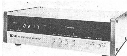
misst das RE 701 auch den Effektivwert von Spannung und Strom sowie den Phasenwinkel zwischen den beiden. Die Leistungsmessung erfolgt von 60 mW bis 2 kW im Frequenzbereich von 40...400 Hz und mit einer Genauigkeit von 1,5 % des jeweiligen Messbereiches. Die Bereiche werden automatisch umgeschaltet. Separate Anzeigen warnen bei Überschreiten der Strom- und Spannungsbereiche. Das Gerät kann wahlweise mit einem BCD-Ausgang ausgerüstet werden.
