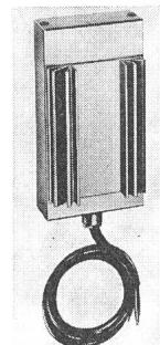
Der eingebaute Thermostat regelt die Eigentemperatur der Geräte auf ungefähr 50 °C. Die Umgebungsluft wird durch das Abstrahlprofil am Aluminiumgehäuse optimal erwärmt. Dadurch kann eine schnelle Luftumwälzung erreicht werden. Es werden 6 Modelle mit Heizleistungen von 10...180 W angeboten. Alle diese Geräte haben eine Schnappbefestigung für die Montage auf 35-mm-Normschienen.
