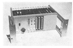
und auch hierarchische Struktur) steht ein Softwarepaket zur Verfügung, das die Kommunikation zwischen den Mikrorechnern gestattet. Da die Datenübertragung mit Interrupts gelöst ist, steht noch genügend Prozessorzeit zur Verfügung, um komplexe Steuerungs- und Regelungsaufgaben zu lösen. Das System ist auf Europakarten in einem 19"-Rack aufgebaut. Die Einsatzgebiete für das MSG-1000-System sind:
