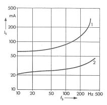
Fig. 8 Ansprechgrenze ( $K_{\mathrm{s}}=2$ ) als Funktion der Frequenz
