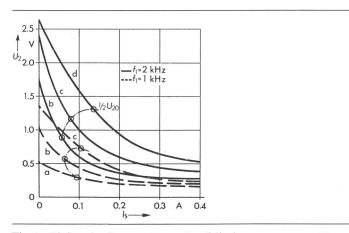
Fig. 3 Einfluss des Summenstromes  $I_s$  auf die Ausgangsspannung  $U_2$  $f\ddot{u}r f_s = 50 \text{ Hz}$
