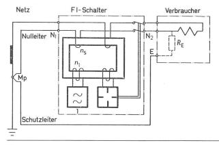
Fig. 9 Bildung einer geschlossenen Windung bei Kurzschluss zwischen Nulleiter und Schutzleiter bzw. Erde
