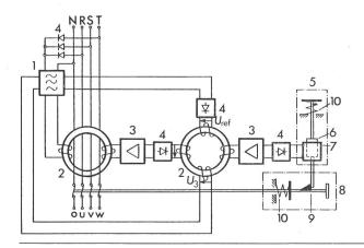
Fig. 6 Hochempfindliche Schaltung für Ruhestrom-Auslöser
