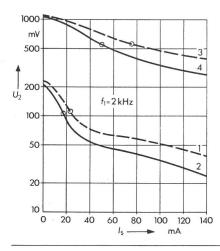
Fig. 7 Einfluss des Filters für die dreifache Frequenz von f1
