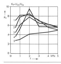
Fig. 4 Frequenzabhängigkeit des Steuerfaktors bei  $I_{\rm s}=0.5~{\rm A},\,50~{\rm Hz}$ Werte für  $I_1$ :
