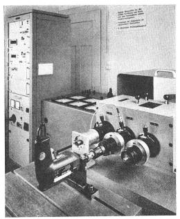
Fig. 9 Universalprüfstand für Handwerkzeuge
