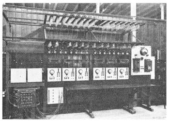
Fig. 4 Glühlampenprüfstand um 1910
