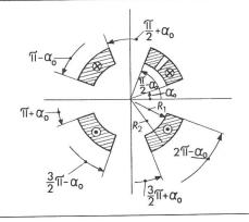
Fig. 4 Dipol mit Doppellagenwicklung
