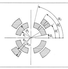
Fig. 6 Quadrupol mit Doppellagenwicklung
