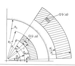
Fig. 2 Zur Ableitung der Magnetfeldkomponenten von Sektorwicklungen mit linear veränderlicher Stromdichte
