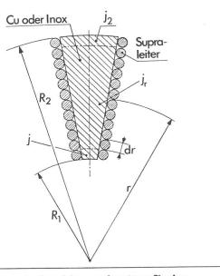
Fig. 1 Anordnung der Supraleiter um einen trapezförmigen, verseilten Kabelleiter
