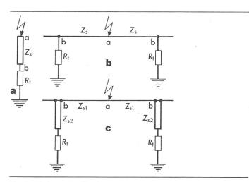
Fig. 2 Trois cas de réflexions dans un système mis à la terre lors du foudroiement du point a
