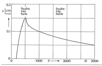
Fig. 4 Part des oscillations dans le courant de foudre au sommet de l'Empire State Building en fonction de l'impédance d'onde de la décharge principale
