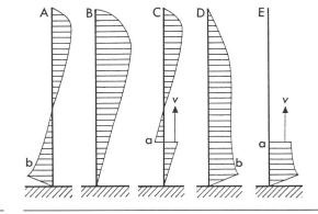
Fig. 7 Répartitions des charges dans le canal de foudre compte tenu de la non-uniformité du champ inducteur
