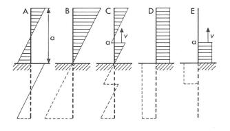
Fig. 6 Répartitions des charges dans le canal de foudre
