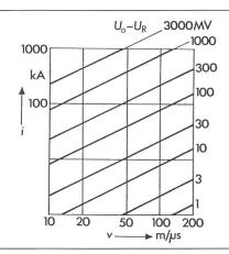
Courant de choc en fonction de la vitesse de la décharge principale pour différentes tensions ( $U_0 - U_R$ )
