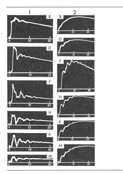
Fig. 5 Oscillations du courant de foudre dans un modèle du mât de télévision de Chorzów
