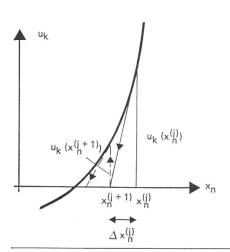
Fig. 4 Newton-Verfahren zur Lösung einer nicht-linearen Gleichung
