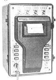
Neu: Typ 616 A/B Kanal A bis 350 V AC Kanal B und C für DC von 4 V bis 50 V
