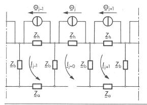
Fig. 3 Réseau équivalent pour une rupture d'anneau (maille j)
