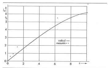
Fig. 11 Courant statorique pulsant relatif en fonction du glissement pour 2 barres cassées; moteur 2. Comparaison calcul-mesure
