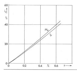
Fig. 14 Courant et couples statoriques pulsants relatifs en fonction du glissement pour un anneau cassé; moteur 1
