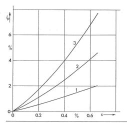
Fig. 9 Courant statorique pulsant relatif en fonction du glissement pour 1, 2 et 3 barres cassées; moteur 1
