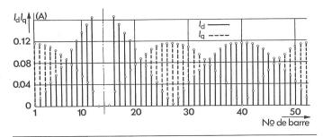
Fig. 7 Distribution des courants rotoriques pour un potentiel statorique de 1A dans le cas de trois barres cassées (barre 13, 14 et 15); moteur 1
