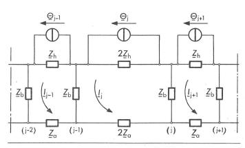
Fig. 2 Réseau équivalent pour une barre cassée (maille j)
