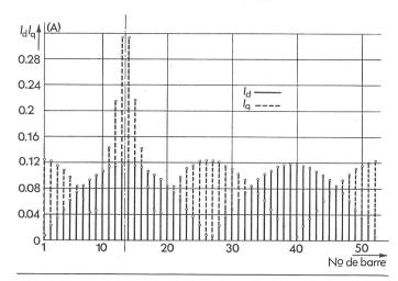
Fig. 13 Distribution des courants rotoriques pour un potential statorique de 1A dans le cas d'un anneau cassé
