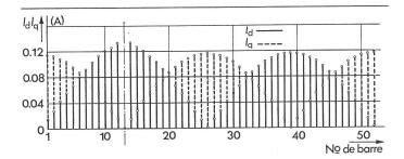
Fig. 5 Distribution des courants rotoriques pour un potentiel statorique de 1A dans le cas d'une barre cassée (barre 13), motour 1
