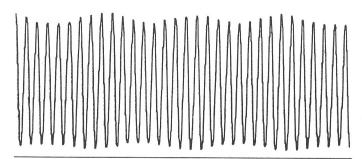
Fig. 12 Courant de phase résultant mesuré pour le moteur 2 avec 2 barres cassées. Glissement 3,16%
