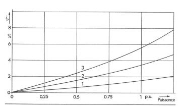
Fig. 8 Courant statorique pulsant relatif en fonction de la charge, pour 1, 2 et 3 barres cassées; moteur 1
