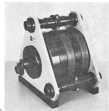
Volant d'inertie constitué de 5 disques séparables  $J = 0.170 \text{ kgm}^2 \text{ par disque}$
