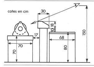
Fig. 3 Profil d'un poste de travail, avec la ligne de visibilité par-dessus le pupitre
