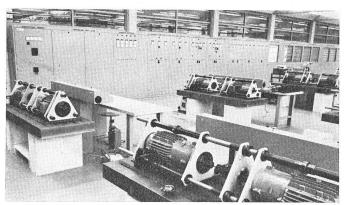
Fig. 2 Vue partielle du laboratoire montrant les bancs d'essais avec machines, les pupitres et les tables de mesure
