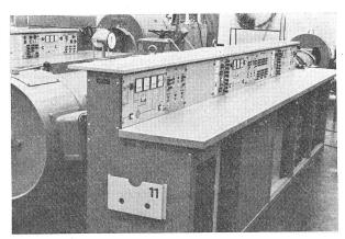
Fig. 8 Messpult der Maschinenhalle für eine Gruppe von drei Asynchronmaschinen
