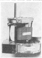
in Platinenausführung, die zusammen mit den Motoren eine organische Einheit in kompakter Bauweise bilden. Die Stufenzahl dieser Getriebe kann variiert und damit der Bereich des feinstufig wählbaren Übersetzungsverhältnisses von etwa 1,5:1 bis 2480:1 sehr gross gehalten werden. Dabei können Leistungen bis rund 130 Wübertragen werden. Die Getriebemotoren können mit Radiallüftern oder Querstromlüftern kombiniert werden.
