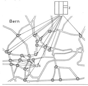
Fig. 4 Schematischer Aufbau eines Zentralsteuerungssystems mit Verkehrscomputer Z, mit einer Signalgruppensteuerung S
