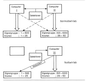
Fig. 7 Duplex-System mit «load sharing»
