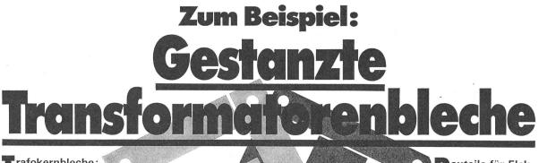
rafokernbleche: Typen M, El, Ul, L, nach DIN 41302. MD-Kernbleche, Drehstrombleche, zugeschnittene und gelochte Blechstreifen. Spezialschnitte, Trafowinkel und Druckstücke sowie Trafogehäuse in Alu-Pressguss. aterial: Elektroblech nach DIN 46 400. Korngerichtetes Transformatorenblech, nach dem Stanzen schutzgasgeglüht.
