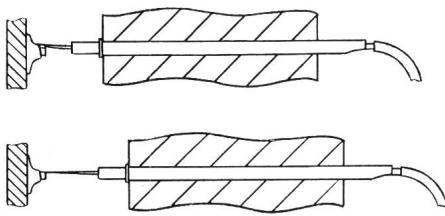
Verfügung. Die Abmessungen der Prüfkontakte bewegen sich zwischen 0,5 mm Durchmesser bei 16 mm Länge und 4 mm Durchmesser bei 40 mm Länge. Der kleinstmögliche Abstand zwischen zwei benachbarten Prüfspitzen beträgt 0,7 mm. Ein durchgehend guter, metallischer Kontakt und gleichbleibender Druck während 1...5 Mio Kontaktspielen werden durch die gelöste Feder gewährleistet.
