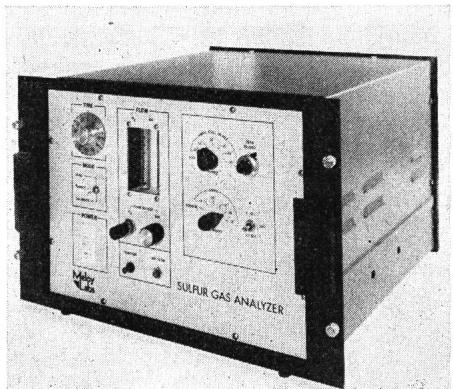
knopfes angewählt. Die Versorgung mit dem benötigten Wasserstoff wird durch eine Hochdruckflasche sichergestellt. Durch geeignete Wahl der Diskriminatoren ist es möglich, das Gerät nur für H<sub>2</sub>S und SO<sub>2</sub> empfindlich zu machen. Zusätzlich sind auch Kalibrierseinheiten lieferbar. Das Analysegerät ist in tragbarer Ausführung oder als Schalttafel-Einbaumodell lieferbar.
