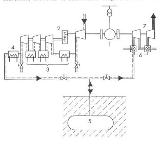
Untergrund bergmännisch hergestellte Hohlräume. Zur Erzeugung von Spitzenstrom wird die Druckluft erhitzt (6) und treibt eine Hochdruckturbine mit 43 bar/550 °C und eine Niederdruckturbine mit 11 bar/825 °C (7).
