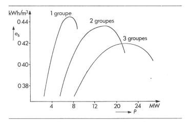
Fig. 2 Energie spécifique e<sub>s</sub> en fonction de la puissance P pour une hauteur de chute donnée
