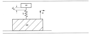
Schéma de principe d'un accéléromètre Fig. 1
