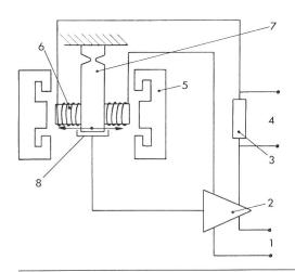
Schéma d'un servo-accéléromètre Fig. 4
