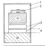
Schéma d'un capteur piézoélectrique
