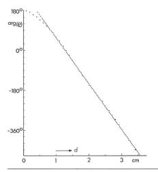
Fig. 5 Phase du facteur de réflexion après adaptation  $\varrho$ , en fonction de la distance d
