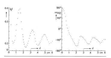
Fig. 2 Amplitude et phase du facteur de réflexion  $\varrho$  en fonction de la distance d  $a=2,286 \text{ cm},\ b=1,016 \text{ cm},\ f=9,03 \text{ GHz}$  (disposition selon fig. 1)
