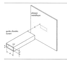
Fig. 1 Guide d'ondes rectangulaire de largeur a et de hauteur b illuminant une plaque métallique située à une distance d
