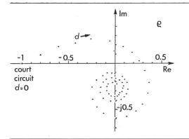
Fig. 3 Diagramme polaire du facteur de réflexion  $\varrho$  en fonction de la distance d
