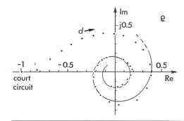
Fig. 4 Diagramme polaire du facteur de réflexion  $\varrho$  après adaptation, en fonction de la distance d
