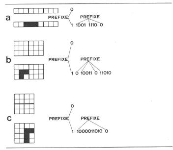
Fig. 4 Principe du codage de blocs auto-adaptatifs
