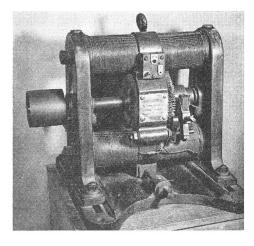
Fig. 1 Machine à courant continu de type Gramme (1877) [1]
