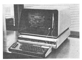
Fig. 1 Simulation d'un réseau électrique à but didactique sur un terminal graphique DEC-GT40
