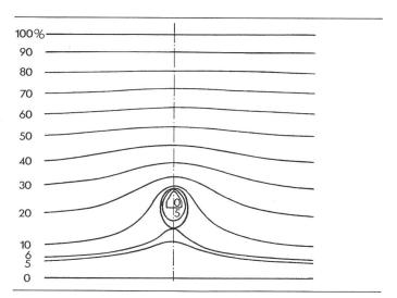
Fig. 4 Tracé de lignes équipotentielles à l'aide du rhéographe et du papier de résistance
