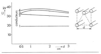
Fig. 7 Variation du seuil d'apparation de l'effet couronne en fonction du nombre et de l'écartement des conducteurs
