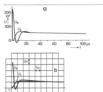
Fig. 13 Calcul (a) et mesure (b) de la propagation d'une onde de choc par la méthode des ondes mobiles
