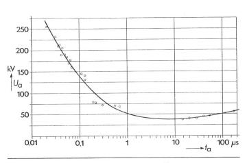
Fig. 12 Courbe tension d'amorçage  $U_a$  – temps d'amorçage  $t_a$  pour un éclateur pointe-plaque (plaque mise à terre) en onde positive, coupée sur le front
