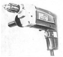
gen Geschwindigkeit in den verschiedensten Materialien, auch Glas, gewölbten Flächen; Schlagbohren in härtestem Beton, ebenfalls mit stufenloser Drehzahlregulierung; Schrauben ein- und ausdrehen; Gewindeschneiden. Technische Daten: 10-mm-Bohrfutter; unbelastete Dreh- und Schlagzahl 0...2600/0...36 000 pro Minute; Leistungsaufnahme 380 W; Nettogewicht 2 kg.
