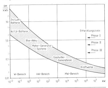
Stromerzeugungskosten konventioneller Systeme und Entwicklungsziele für Solargenerator-Systeme
