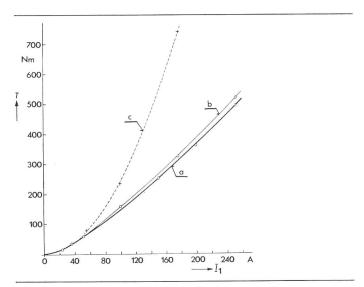
Gemessene (a) und berechnete (b, c) Abhängigkeit des Drehmomentes vom Statorstrom einer 65-kW-Asynchronmaschine, die auf  $\omega_2 = R_2/L_2$  geregelt wird
