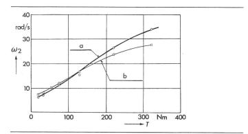
Fig. 2 Gemessene (a) und berechnete (b) optimale Rotorkreisfrequenz  $\omega_2 = R_2/L_2$  für eine 12,5-kW-Maschine
