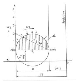
Fig. 1 Das Impedanzdiagramm  $\underline{Z} = \underline{Z}_1/\omega_1$  der Asynchronmaschine
