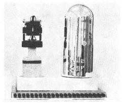
Fig. 7 Aufbau des OFMET-Kalorimeters Entfernt sind die äussere Isolation und ein Dewargefäss
