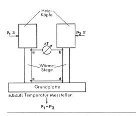
Fig. 6 Prinzipskizze des OFMET-Kalorimeters für elektrische Leistungsmessung
