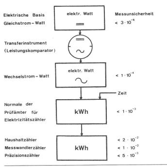
Anschluss der Haushaltzähler an die elektrische Basis Fig. 10 des OFMET
