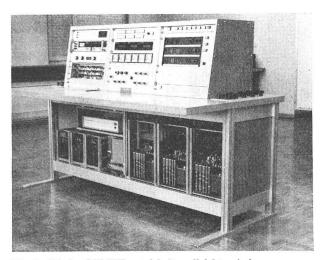
Fig. 9 Die im OFMET entwickelte vollelektronische Zählereichstation
