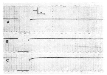
Fig. 8 Stabilität der AC-Speisung des OFMET
