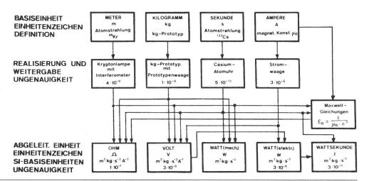
Fig. 1 Praktische Ableitung der elektrischen Einheiten aus den Basiseinheiten
