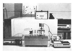
Fig. 3 Spannungsbasis des OFMET
