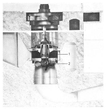
Fig. 1 Exemple de turbine Kaplan
