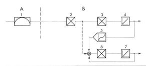
Fig. 2 Schéma fonctionnel d'une conjugaison roue/vannage dans un régulateur mécanique
