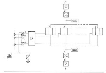
Fig. 5 Schéma fonctionnel de la came électronique
