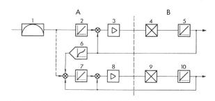
Fig. 4 Schéma fonctionnel d'une conjugaison roue/vannage avec came électronique
