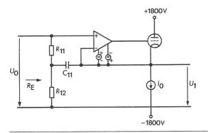
Fig. 2 Aufbau des Eingangsverstärkers I<sub>0</sub> Ideale Stromquelle
