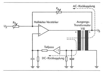
Fig. 4 Prinzipschema für Verstärker 3 in Fig. 3
