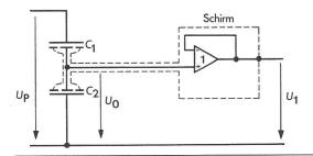
Fig. 1 Kapazitätsteiler und Eingangsverstärker
