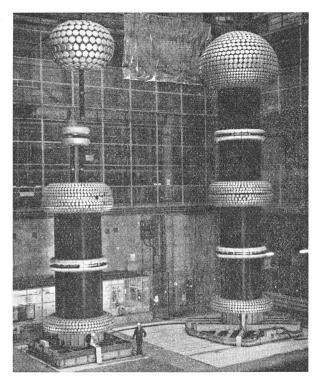
ig. 4 Drei Transformatoren in Betrieb bei der CESI in Mailand; hier ein Transformator für 800 kV und eine Kaskade für 1600 kV
