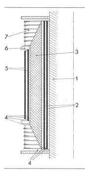
Fig. 2 Spulenquerschnitt einer 400-kV-Spule
