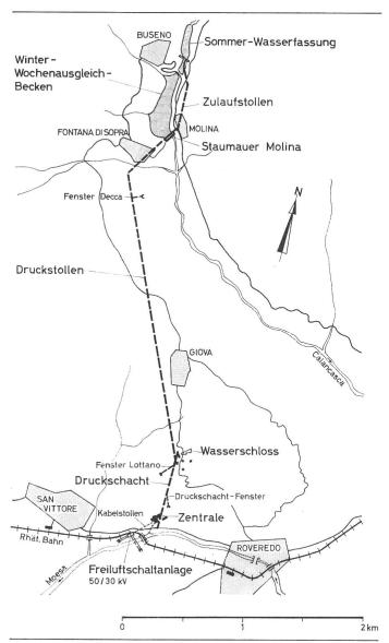
Fig. 2 Übersichtsplan des Kraftwerkes Calancasca
