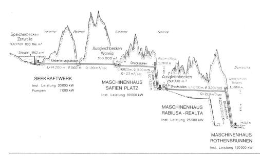
Fig. 3 Längenprofil
